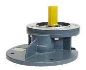
A construção do PC é modular e, portanto, pode ser como uma unidade separada montada em qualquer tipo de motor engrenado adaptado (PAM). A montagem do módulo helicoidal de pré-estágio na unidade de redução principal é facilmente feita para qualquer tipo de motor B14. A unidade de pré-estágio não pode ser usada por si só, apenas acoplada a outra unidade de redução.
