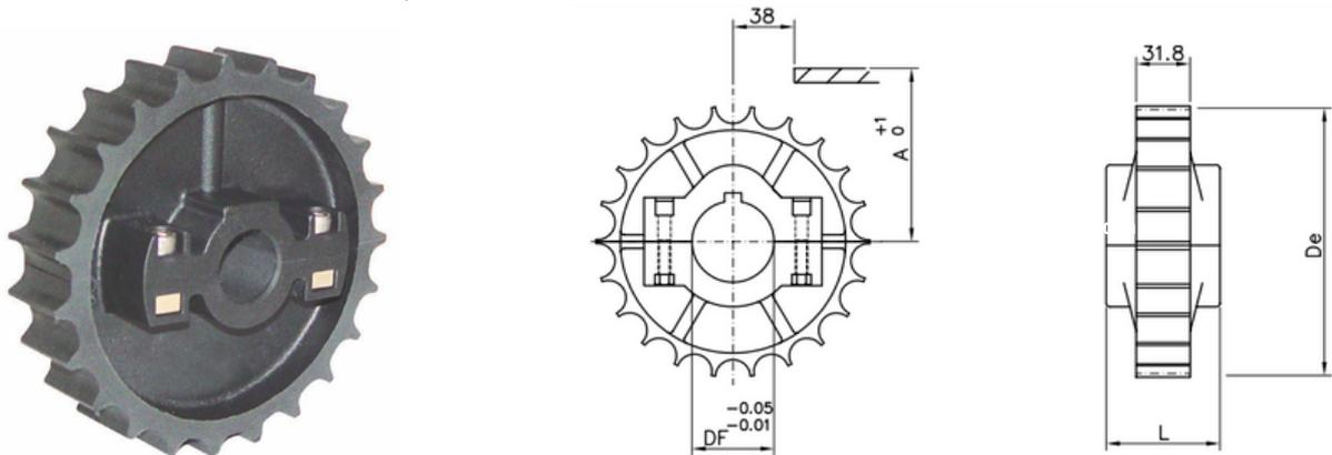
Material : poliamida reforçada - parafusos em aço inoxidável, porcas em latão níquelado - UNI 6604
